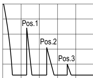
Bild D-3: Erzeugen von Bezugshöhen von Querbohrungen aus unterschiedlichen Entfernungen des Prüfkopfes für die Schrägeinschallung
