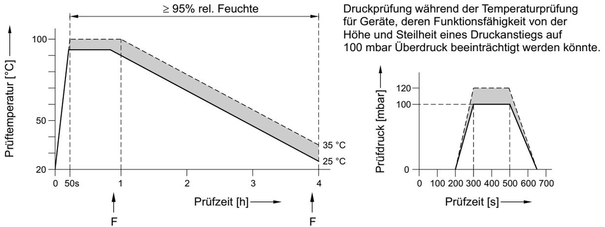
Toleranzband der Prüftemperatur oder des Prüfdruckes
